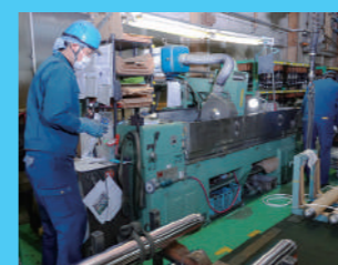
最終工程・円筒鏡面仕上げ研磨機
